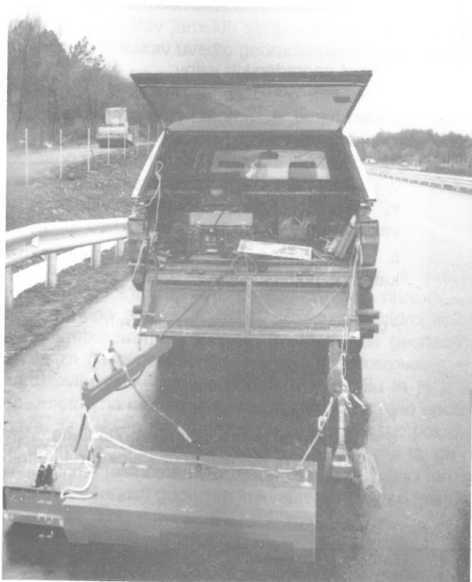
Slika 4: Dvokanalni GPR sistem - Geophysical Survey System, Inc. (GSSI) Subsurface Interface Radar (SIR) System - 10.
